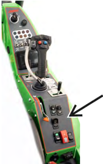
Alle schakelaars zitten bij de handgashendel
